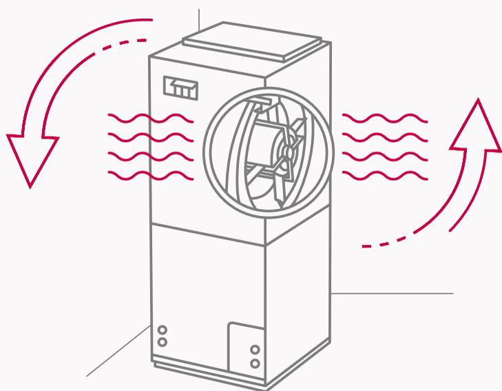
Le moteur à vitesse variable du CBA38MV sait exactement à quelle vitesse il doit tourner pour maintenir votre confort; par conséquent, il accélère ou ralentit selon les besoins. Puisqu'il ne fait pas d'efforts inutiles, il ne gaspille pas d'énergie. Et cela se traduit par des factures d'énergie moins importantes.
